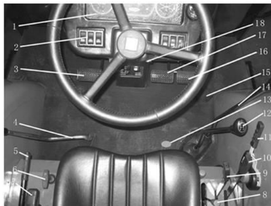
Рис. 3-1 Схема механизма управления
