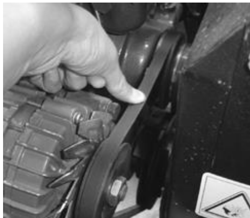
Рис. 5-21 Регулирование натяжения резиновой ленты вентилятора
