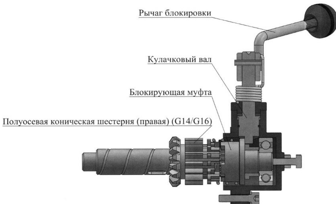
Рис. 7. Механизм блокировки дифференциала
